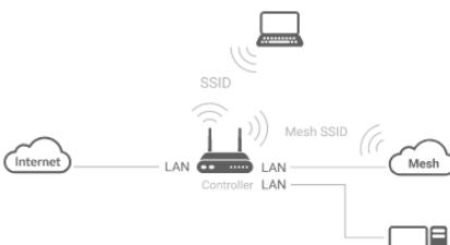
Рисунок 38. Настройка функции EasyMesh для главного устройства. Режим **Маршрутизатор**.
