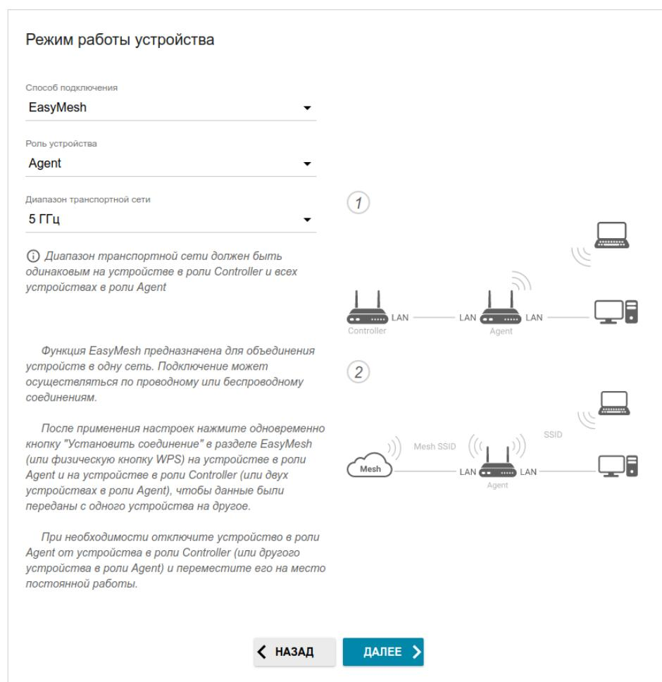
Рисунок 40. Настройка функции EasyMesh для зависимого устройства.
