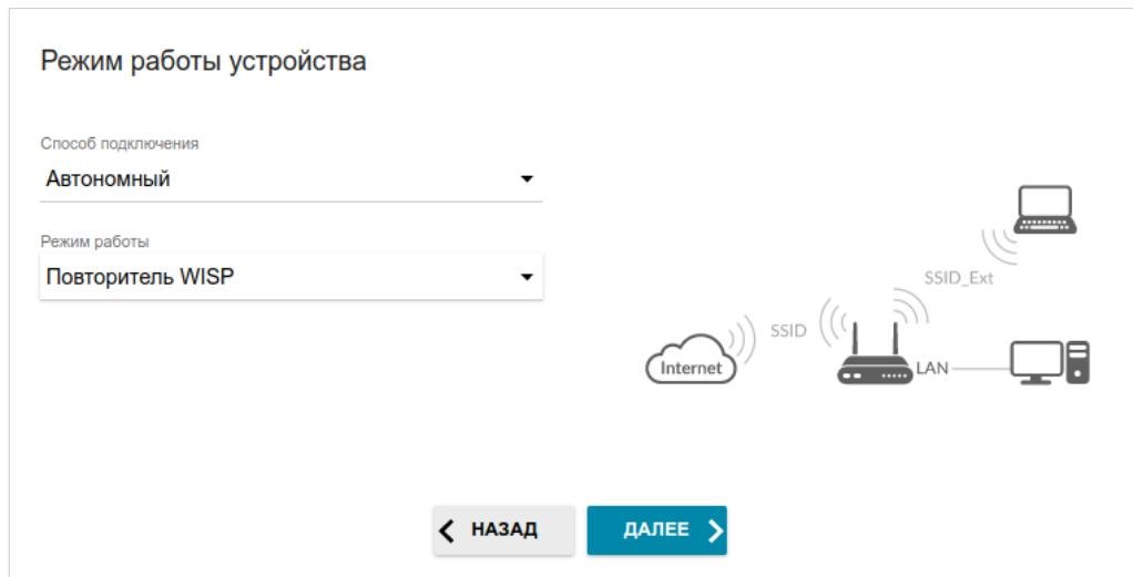
Рисунок 34. Выбор режима работы устройства. Режим Повторитель WISP.
