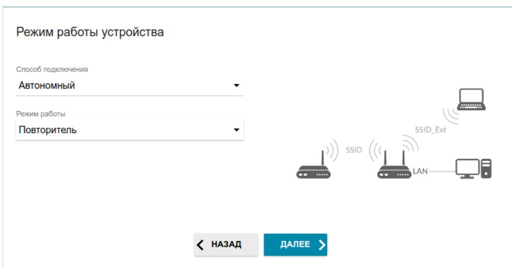
Рисунок 36. Выбор режима работы устройства. Режим **Повторитель**.
