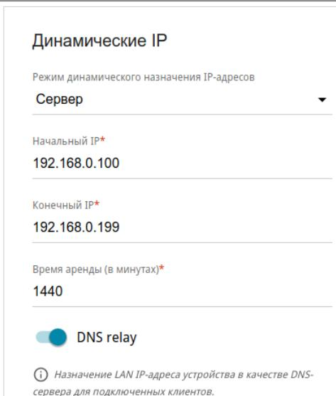
Рисунок 88. Настройка локального интерфейса. Вкладка **IPv4**. Раздел **Динамические IP**.
