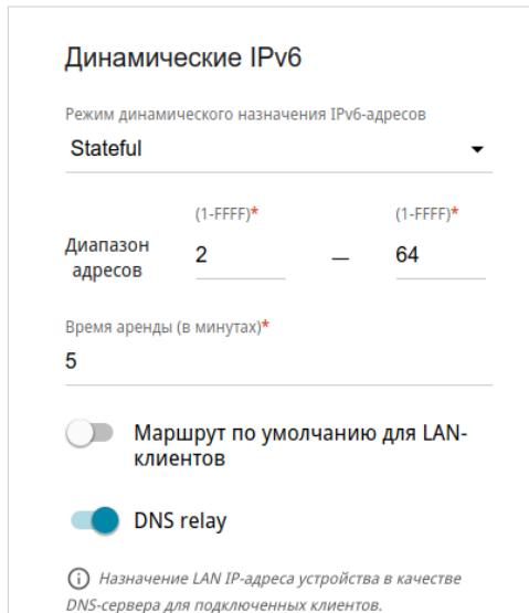
Рисунок 95. Настройка локального интерфейса. Вкладка **IPv6**. Раздел **Динамические IPv6**.
