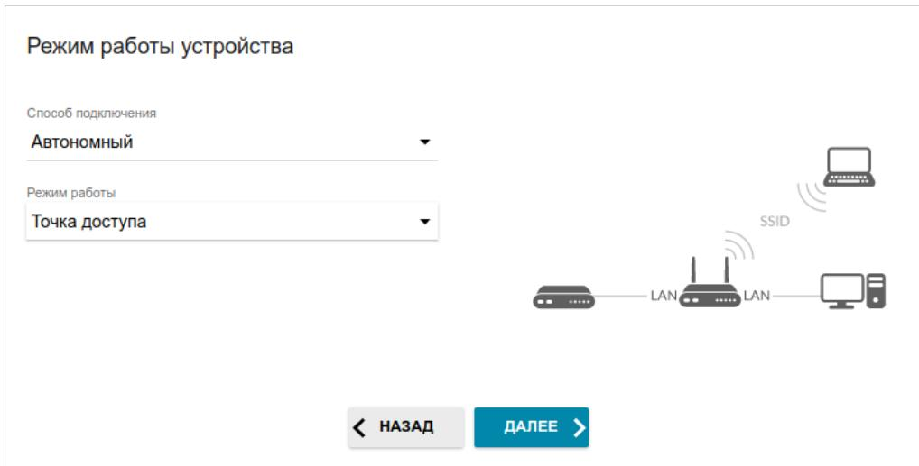
Рисунок 35. Выбор режима работы устройства. Режим **Точка доступа**.
